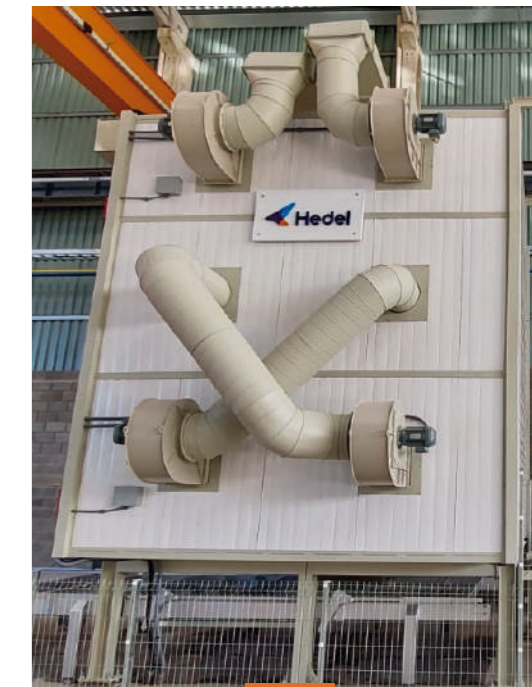
Forno vertical de duas câmaras que permite a secagem e catalise das chapas no mesmo equipamento.
