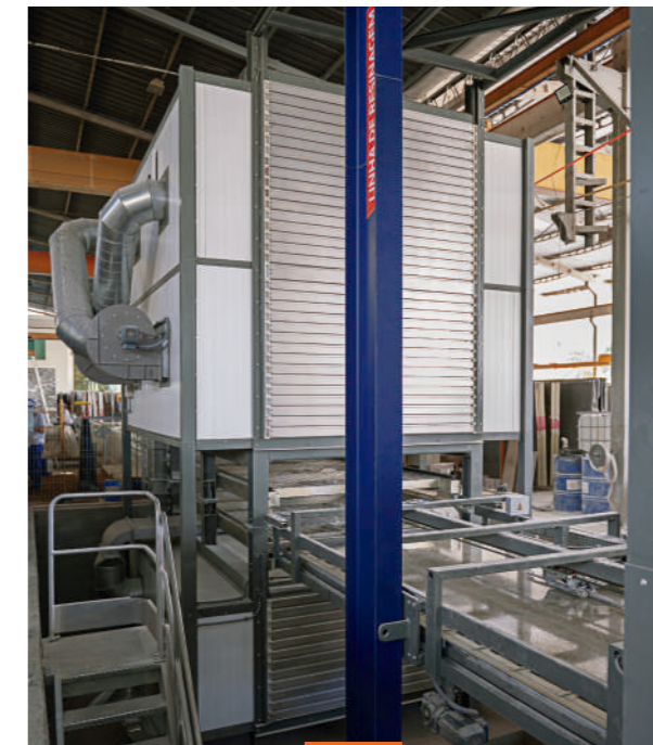
Forno com opção para galpão baixo, é possível instalar o forno parcialmente abaixo do nível do piso do galpão.
